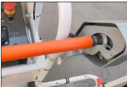
Рисунок - Активированное состояние устройства защиты
